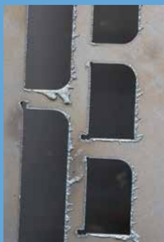
Vorher: Das Blech nach Bearbeitung durch die Plasmaschneidanlage ...
