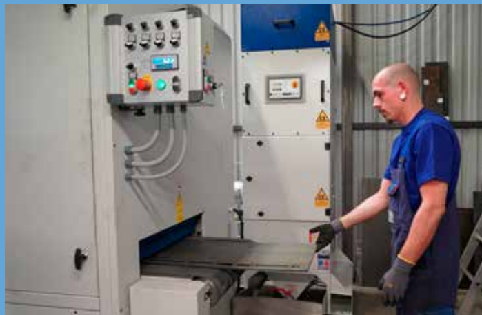
Bei der neuen Loewer Schleifmaschine brauchen die Bleche zur Bearbeitung nur eingeschoben zu werden. Die Metallbauer werden von manuellen Nacharbeiten entlastet, zusätzliche Arbeitskapazitäten gewonnen.
