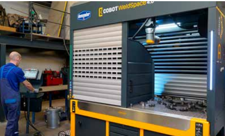
Der Arbeitsplatz, an dem der Roboter schweißt, ist mit einem Rolltor verschlossen, während der zweite Tisch ent- oder beladen werden kann.
