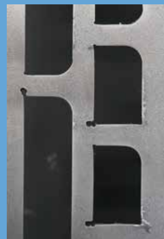
Nachher: ... das Blech nach Bearbeitung mit der Loewer Schleifmaschine.
